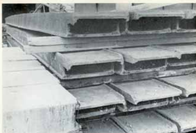
LA VIGA TUBULAR, PRINCIPIO DE UN NUEVO Y DENSIO CAMPO DE POSIBILIDADES
